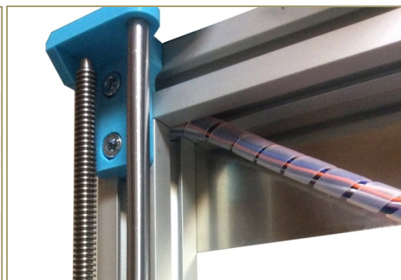
OBRÁZEK 52: PROTAŽENÍ KABELOVÉHO SVAZKU
